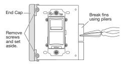
Fig. 10: Remove End Cap and fins
